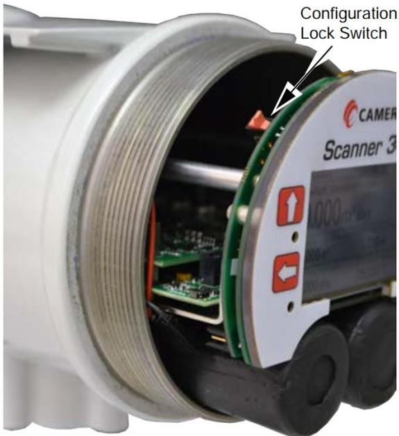
**Figure 5 – Internal Physical Sealing Switch / Interrupteur à scellage physique interne**
