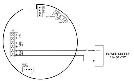
Figure 2.5—Reset input wiring (switch/power supply)
