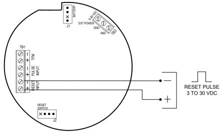
Figure 2.6—Reset input wiring (pulse)
